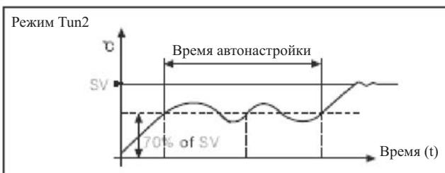
Функция автонастройки периодически включается, т. к. температурные характеристики контрольного объекта могут меняться, если контроллер функционирует непрерывно длительное время.
